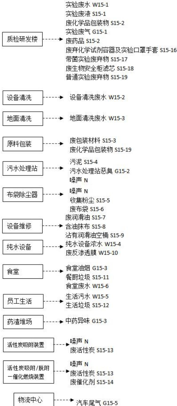
图 4.2-15 其他工艺流程及产污环节图
